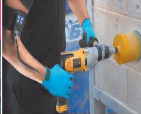
Resim 12. Kişilerin Maruz Kaldığı Elle İletilen Titreşimin Ölçülmesi
