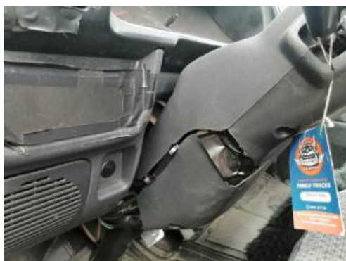
Foto 27 PARTE BAJA TABLERO PARTIDO
