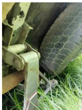
Foto 16 SUSPENSION CON OXIDO
