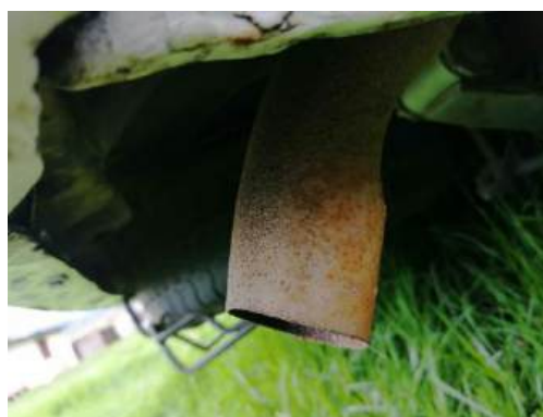
Foto 14 PARTE BAJA CON OXIDO
