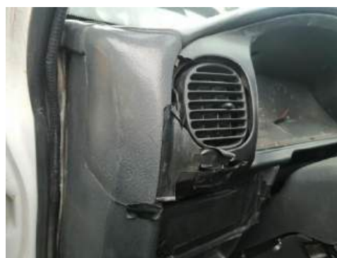
Foto 26 COSTADO IZQ TABLERO PARTIDO
