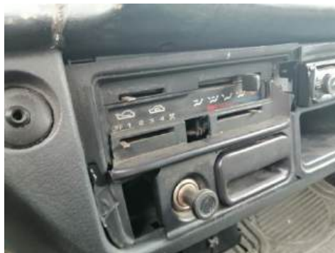
Foto 28 PARTES FALTANTES DE TABLERO
