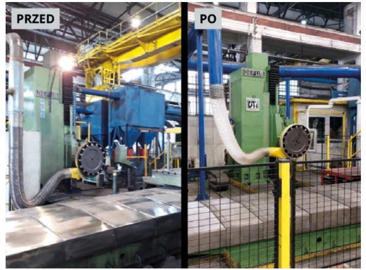
▲ Efekt 6-miesięcznej modernizacji w DTi: wytaczarka DEFUM z usztywnioną strukturą i nowym łożyskowaniem wrzeciennika osiąga dziś dokładności i stabilność obróbki fabrycznie nowej jednostki.
