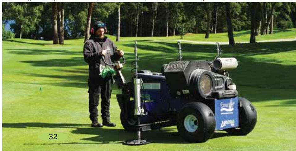
Air2G2 frigjør kraftige støt med komprimert luft som sprer seg horisontalt og vertikalt under bakken.
