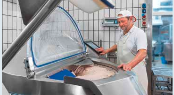
Die Albmetzgerei Failenschmid setzt auf den Vakuum-Kochkutter VCM 120 (li.) und den Misch-Winkelwolf MWW 130 mit Kisten-Hebesystem Easy Lift.
