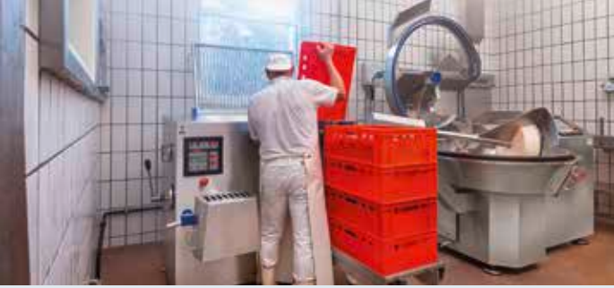
Die Albmetzgerei Failenschmid setzt auf den Vakuum-Kochkutter VCM 120 (li.) und den Misch-Winkelwolf MWW 130 mit Kisten-Hebesystem Easy Lift.
