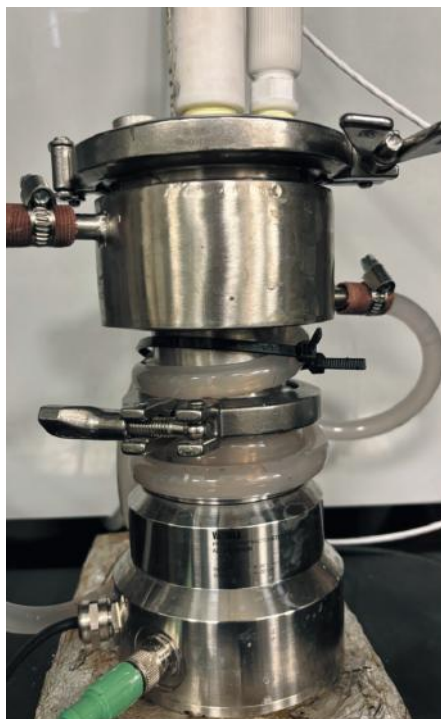
Obr. 1: Laboratorní nerezový reaktor (400 ml) s duplikací osazený ve dně sondou procesního refraktometru Vaisala Polaris PR53AC. Ve víku jsou průchody pro externí PT100 termostat, míchadlo a dávkování.
