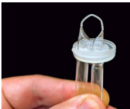
Duté vlákno s kapalnou extrakční membránou připravené k separaci léčiv z moči, foto: Heyrovského ústav AV ČR
