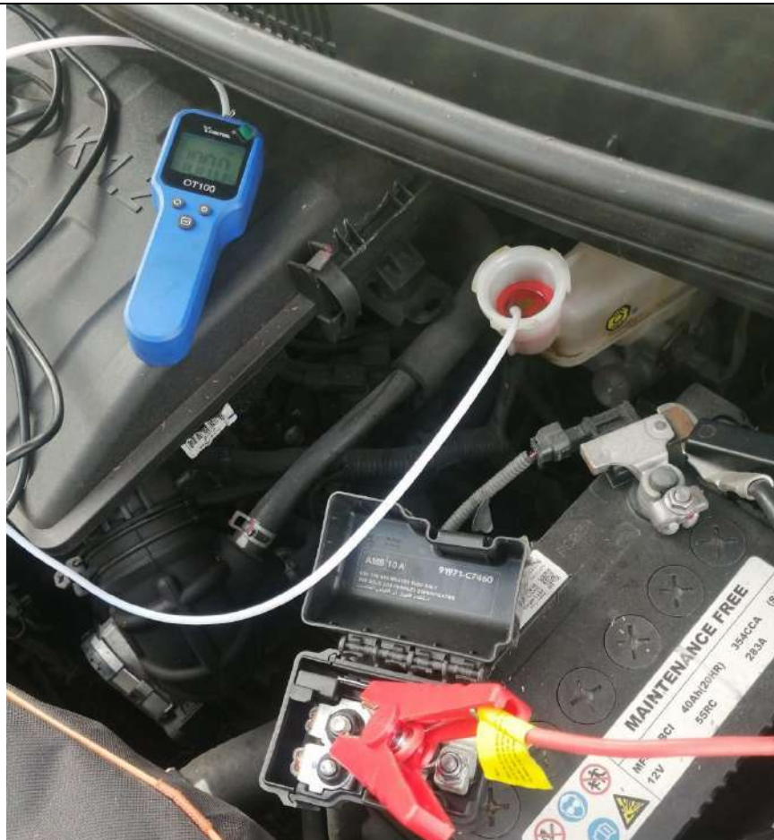
TOMA DE FLUIDOS DEL VEHICULO Y CONEXION A BATERIA EXTERNA
