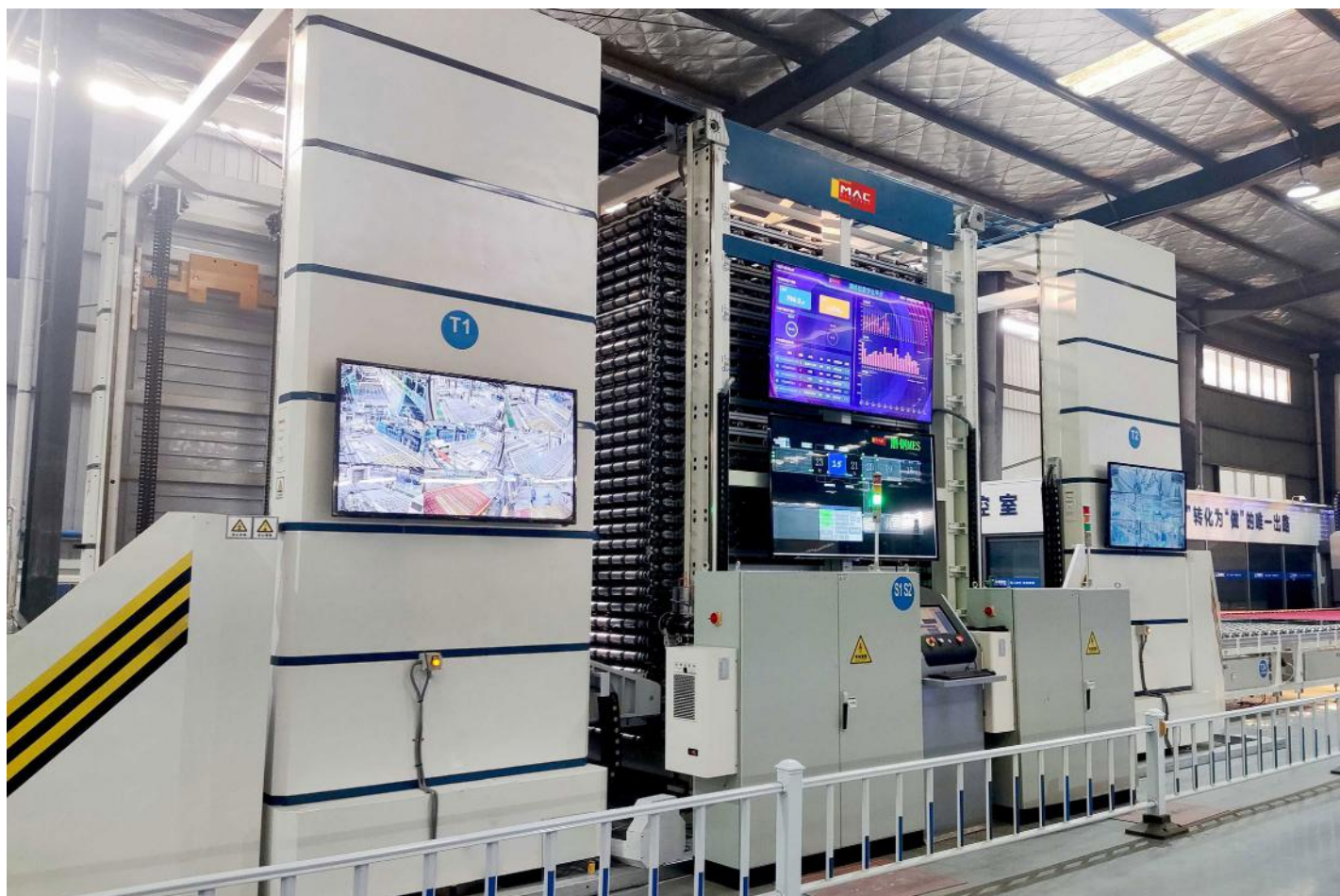
Sistema de clasificación previo al horno de templado conectado al ERP vía cloud.
