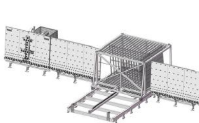
Almacenamiento de remanentes en línea
