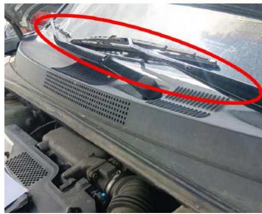
Foto 8: Cauchos de Plumas limpiaparavidrios delanteras se encuentran resacas.
