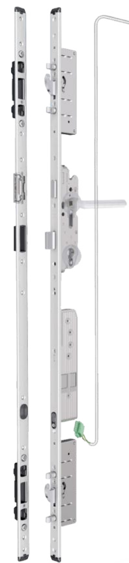
Cod. D6005 Winnertronic - Serratura di sicurezza motorizzata a sette punti di chiusura con una mandata, due ganci e quattro punzoni.
