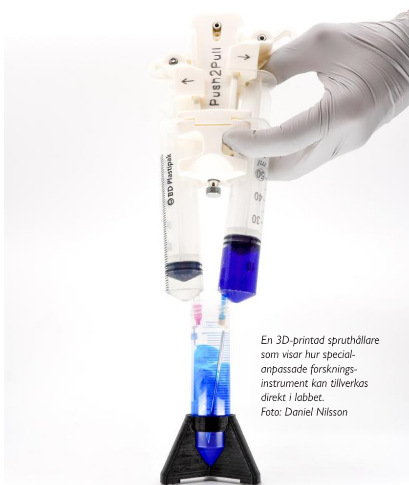
3D-utskrivna forskningsinstrument kan anpassas efter specifika behov i laboratoriet. Foto: Daniel Nilsson
