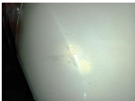
Defecto de pintura 4 (parachoques posterior lado conductor)
