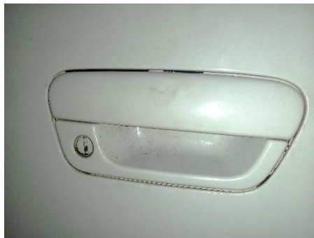
Defecto de pintura 1 (manubrio puerta acompañante)
