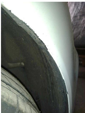
Defecto de pintura 2 (filo rueda delantera lado acompañante)
