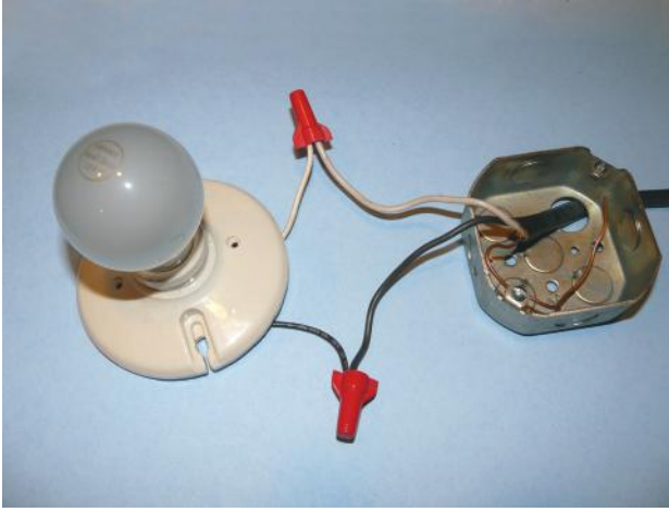
Şekil 5-16 Ampül fişstüründen gelen tellerle, iletken (siyah) ve nötral (beyaz) tellerin karşılıklı bağlandığı basit bir ampül devresi.
