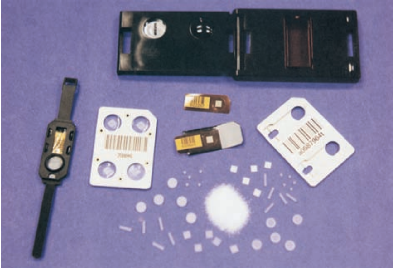
ŞEKİL 40-5 Termoluminesans dozimetreler çipler, diskler, çubuklar veya toz halindedir. Bunlar, alan ve çevresel radyasyon ve özellikle mesleki radyasyon izlemi için kullanılır. (Bicron Electronics nezaketleri ile.)
