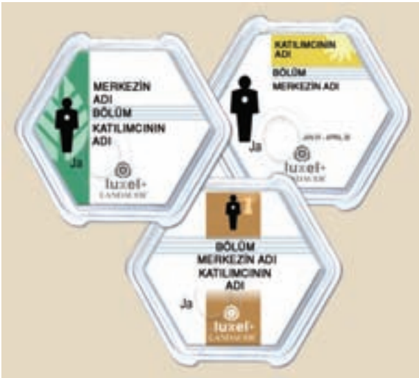
ŞEKİL 40-6 Optik uyarılan lüminesans dozimetreler (Linda Bosy nezaketleri ile, Landaeur, Inc.)
