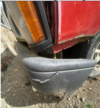
Guarda choques roto
