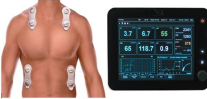
Şekil 13. Non-invaziv hemodinamik monitorizasyon sistemi (biyoreaktans/biyoimpedans temelli kalp debisi ve dolaşım parametrelerinin izlenmesi)
