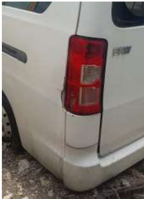
Oxidos y daño de latonería
