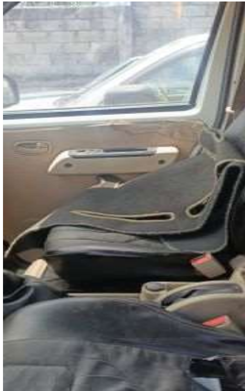
Tapinería de puerta deteriorada
