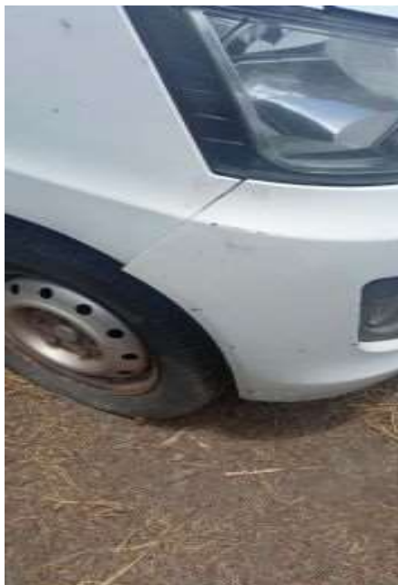
Descuadre de piezas Llantas enterradas en mal estado
