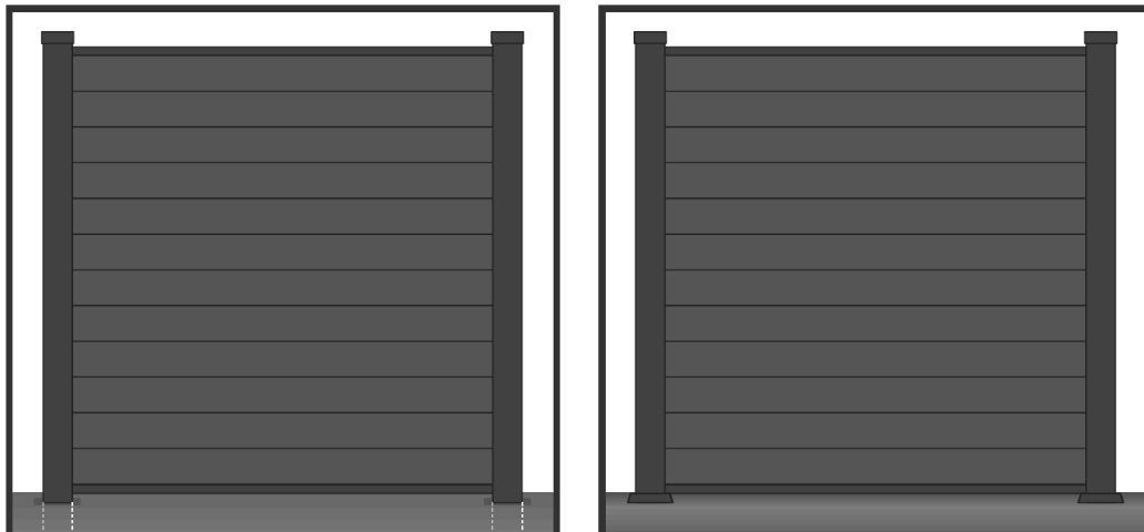
FIG. 1 – MONTAGEOPTIONEN – BETONFUNDAMENT (LINKS) UND VORBEREITETES FUNDAMENT (RECHTS)
