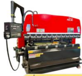
เครื่องพับโลหะ AMADA รุ่น RG-100S
