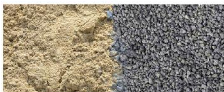
Áridos: Arena lavada y grava de varias granulometrías
