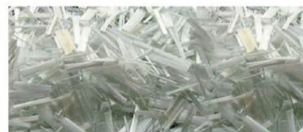
Refuerzo: Fibra de vidrio para mayor resistencia
