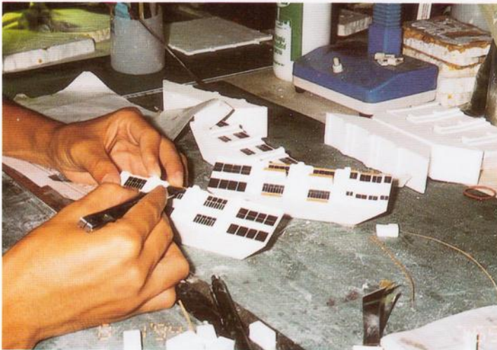
การเพิ่มเติมรายละเอียดต่างๆ ภาพล่างแสดงการใช้วัสดุคือแผ่นฟิล์มเอกซเรย์ที่ใช้แล้วทำผนังต่าง
