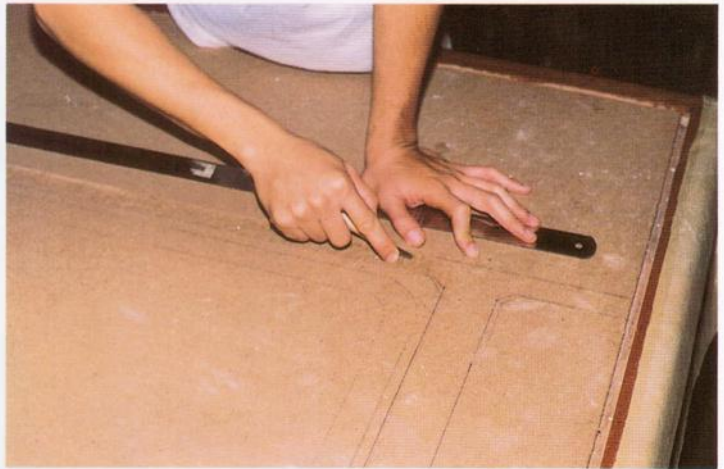
ตีฝั่งและประกอบขึ้นส่วนลงบนฝั่ง ส่วนใจกลางอาคารจะปล่อยโล่งว่างเพื่อลดน้ำหนัก ทุ่นจำลองอาคารนี้เป็นชนิดปิดหลังคา หากทำทุ่นจำลองเพื่อเปิดหลังคาดูรายละเอียดภายในอาคารจะใช้เวลานานและทำยากขึ้น
