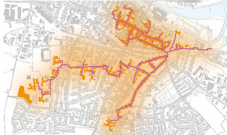
Voraussichtliche Trassenführung des Wärmenetzes EmsWärme in Warendorf
