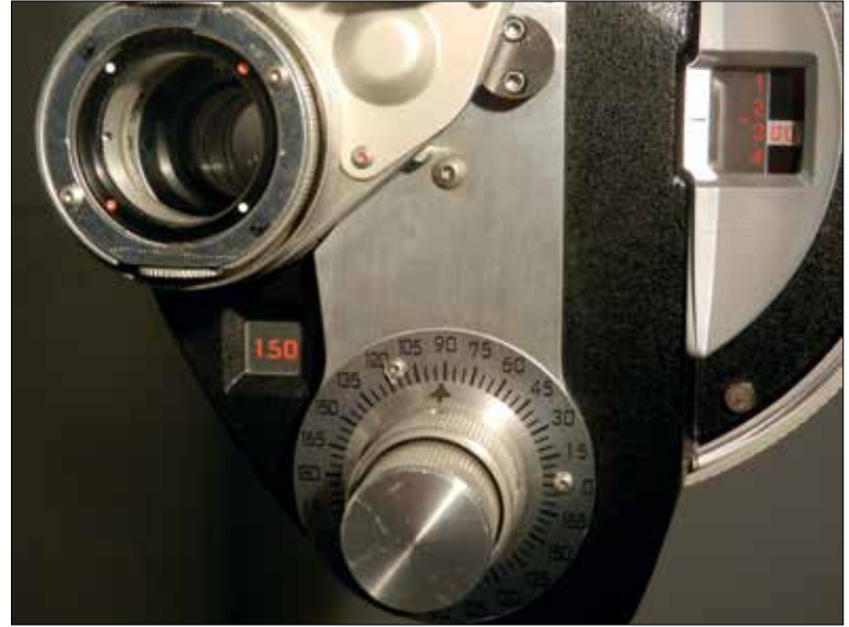
Şekil 2.3.9 Refraktöre monte edilmiş Jackson çapraz silindir, 90° eksenli silindirin eksen yönünün kontrolü için yerleştirilmiştir.
