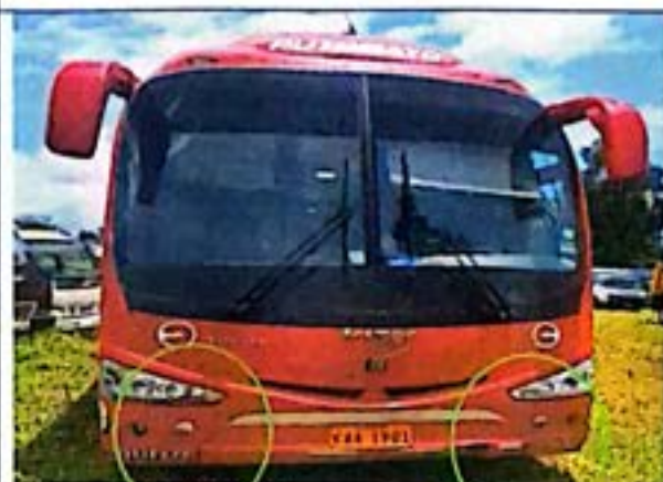
Fotografía Digital de conjunto No. 7 y 8 del Vehículo sometido a pericia, donde se observa el guardachoque con sus rayones y hundimientos en su superficie del guardachoque.
