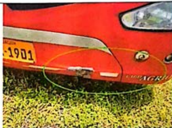
Fotografía Digital de conjunto No. 7 y 8 del Vehículo sometido a pericia, donde se observa el guardachoque con sus rayones y hundimientos en su superficie del guardachoque.
