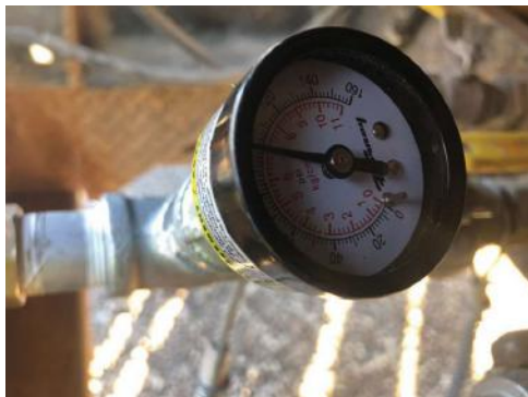
Figs. 1 y 2: Manómetro (ARRIBA) para la medición de presión y medidor de flujo (ABAJO) para la medición del volumen de aire.
