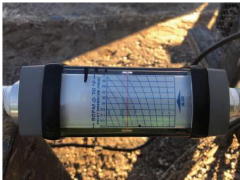
Figs. 1 y 2: Manómetro (ARRIBA) para la medición de presión y medidor de flujo (ABAJO) para la medición del volumen de aire.
