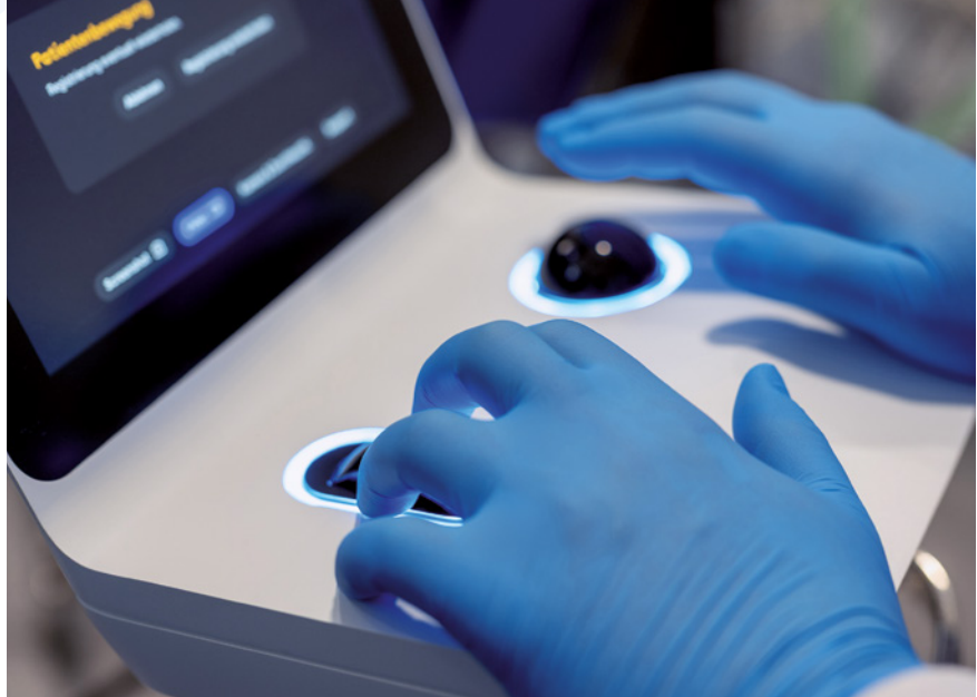
Die Katheter- und Sichtsonde wird mittels Scrollrad und Trackball gesteuert.
