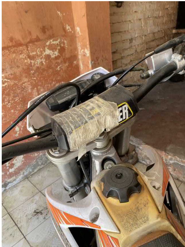
Fotografía No. 9 Daño esponja protectora de timón
