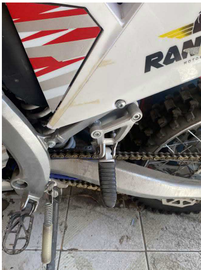
Fotografía No. 7 Daño en pedal de apoyo posterior
