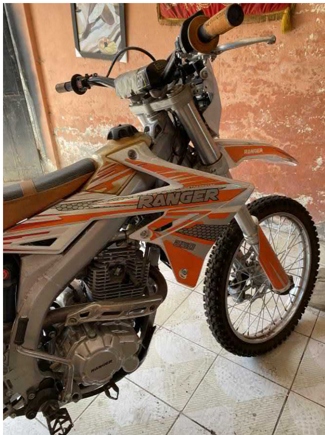
Fotografía No. 5 Suspensión buen estado, sin fuga de líquido
