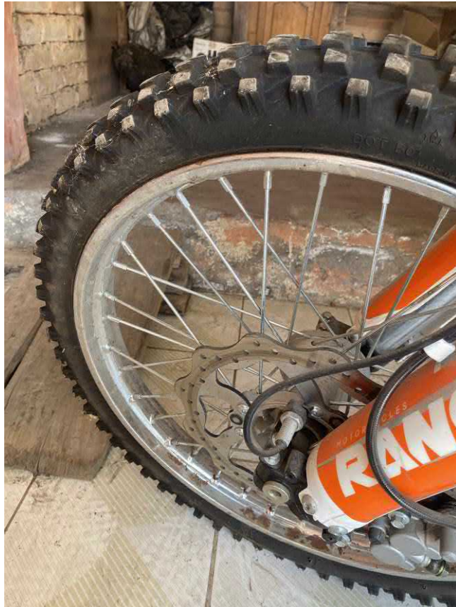
Fotografía No. 10 Deterioro en aro delantero, oxidación
