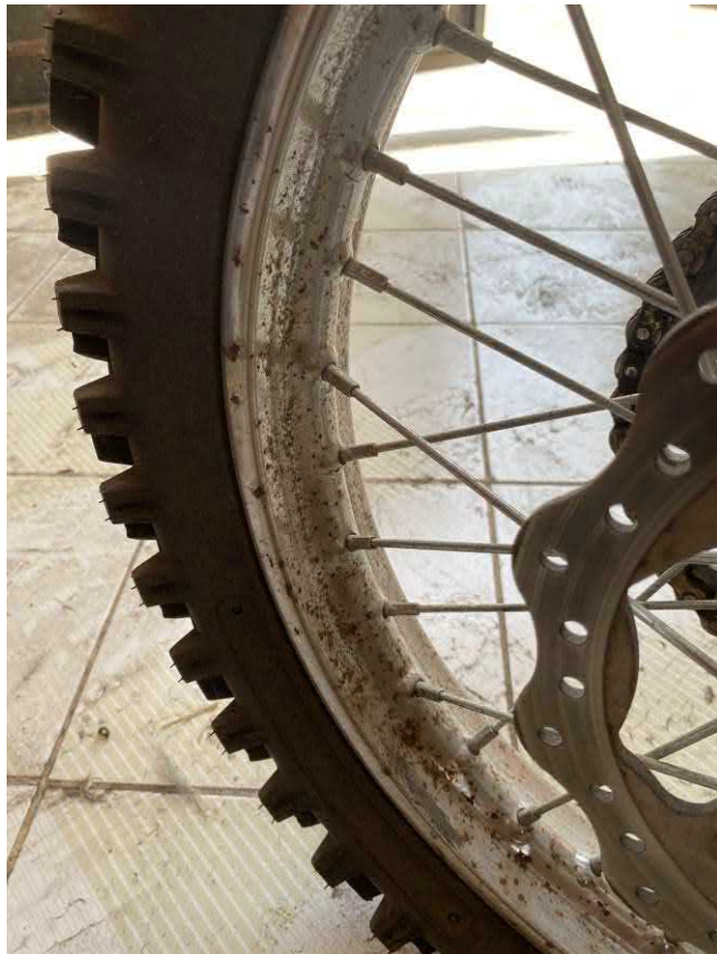
Fotografía No. 11 Deterioro en aro posterior, oxidación
