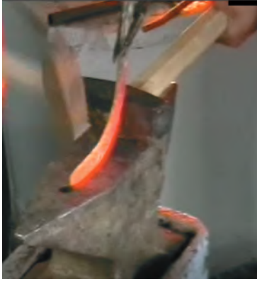
Şekil 19.39. Kızgın demirde nala hilal şeklinin verilmesi.
