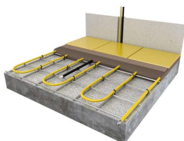
Instalación con mallazo y bridas
