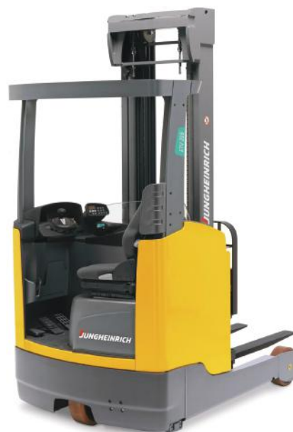
Fig. 3: Un montacargas retráctil común con ruedas pequeñas y duras.
