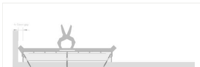
FIG. 4 – OUTIL DE FIXATION LATÉRALE BRIDÉ SUR UNE LAMBOURDE, JEU DE 4-5 MM
