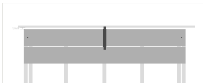
FIG. 3 – PREMIÈRE LAME FIXÉE AUX DEUX EXTRÉMITÉS AVEC LA VIS FINE
