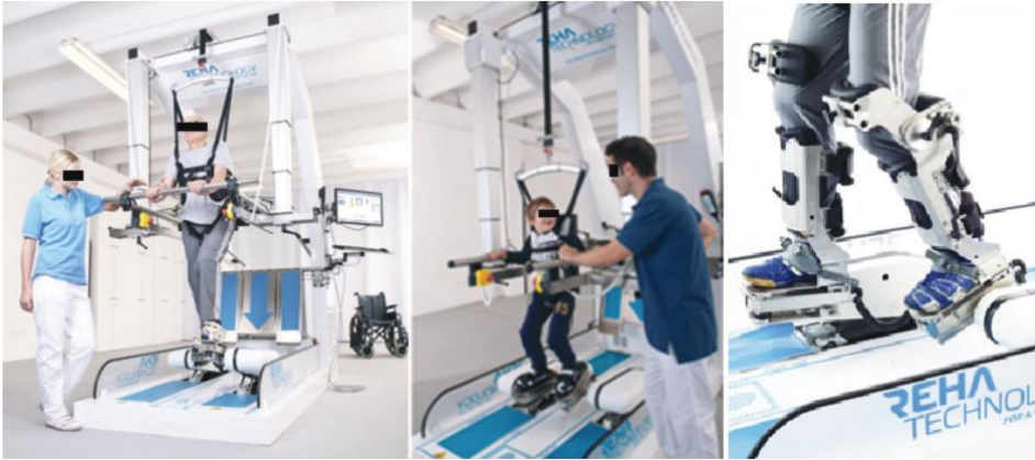
Resim 22 • G-EO Sistem: Erişkin ve çocuk modülleri olan bu sistemde hasta, bir harnes takımı üzerinden askıya alınarak vücut ağırlıkları desteklenir. Ayaklar cihazın ayak tabanlarına bağlanır. Koşu bandı olmayan bu sistemde, zemin yürüyüşü, merdiven yürüyüşü ve kısmi hareket şeklinde yürüyüş modlarında terapi yapılabilir. Kaynak: "https://www.rehatechnology.com/en/products/g-eo-system". G-EO System. Reha Technology. n.d. Web. 15 December 2017.
