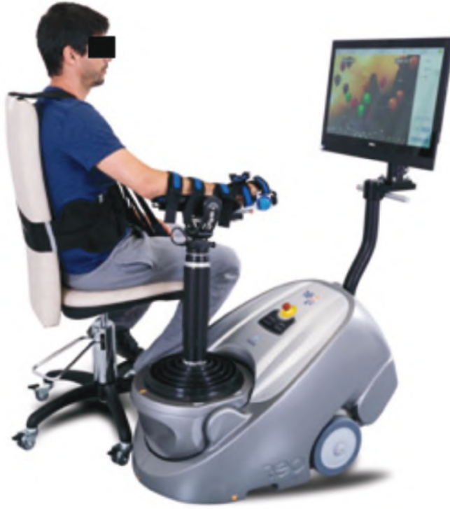
Resim 11 • ReoGo: Hasta oturur pozisyondayken robot koluna bağlanan ön kol ateli ile üç boyutlu sanal görüntü ortamında kendisine özgü egzersizleri gerçekleştirir. Kaynak: " http://motorika.com/product-1/ ". ReoGo. Motorika. n.d. Web. 10 December 2017.
