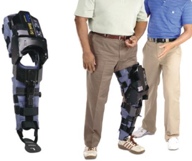
Resim 26 • Bionic bacak cihazı (AlterG): Diz-ayak bilek ortezi şeklindeki cihazın ayakkabı içerisine konulan ince bir tabanlıktaki basınç sensörleri ve cihazın üst kısmına monteli ayarlama düğmeleri ve küçük bir LCD ekran vardır. Kaynak: "https://www.alterg.com/products/bionic-leg/professional-physical-therapy". Robotic Rehabilitation Therapy for Neuro and Ortho Patients. Alter G. n.d. Web. 18 December 2017.
