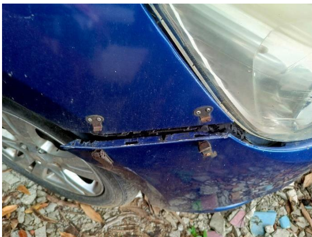
3. Vista daño en guardachoque.
