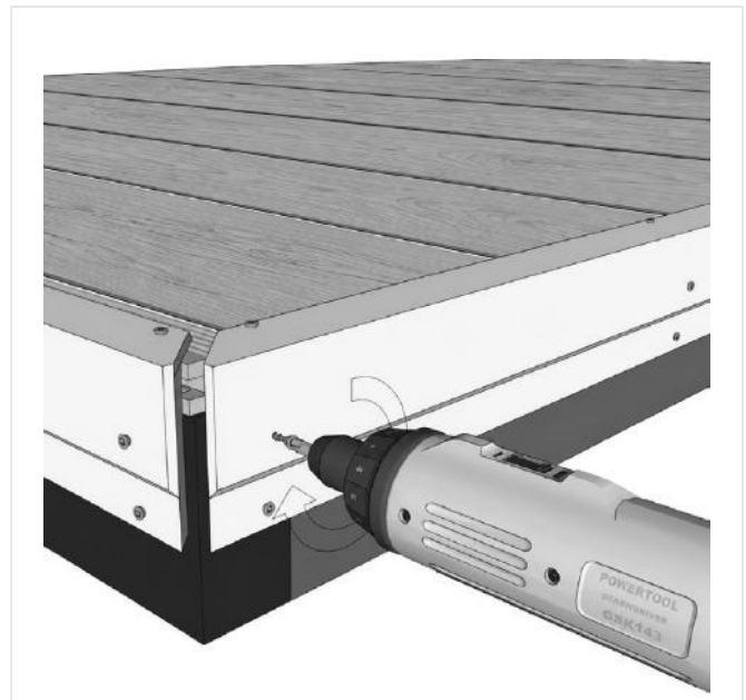
FIG. 26 – ECKPROFIL MIT GESENKTEN SCHRAUBEN BEFESTIGT
