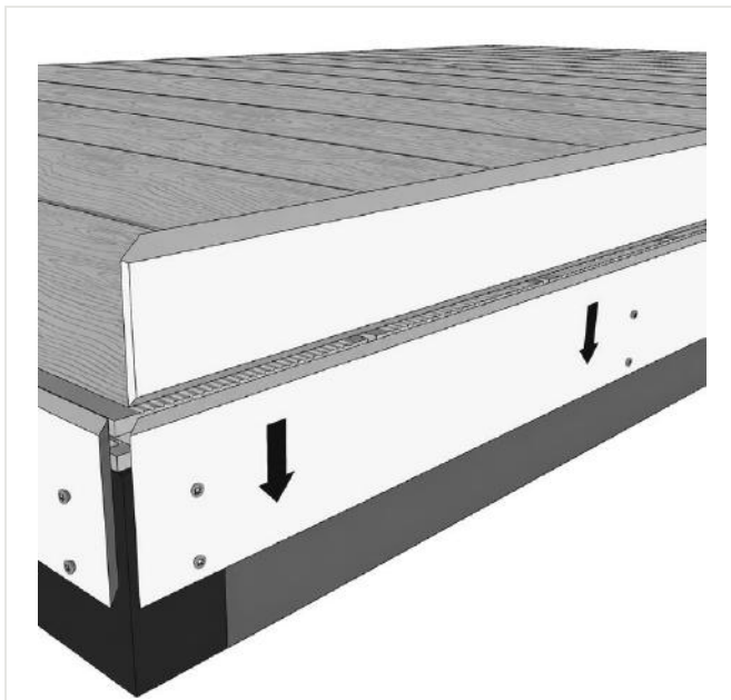
FIG. 25 – ECKPROFIL ÜBER DIE TERRASSENKANTE GELEGT
