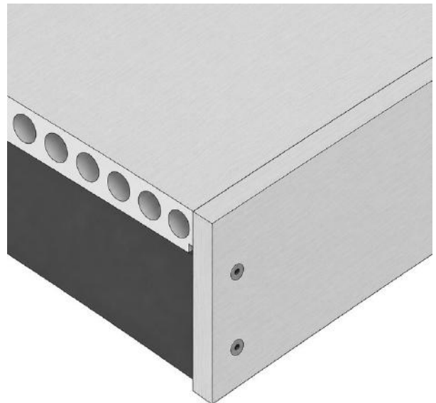
FIG. 24 – GESENKTE VORBOHRUNGEN DURCH DIE BLENDE VORGEBOHRT
