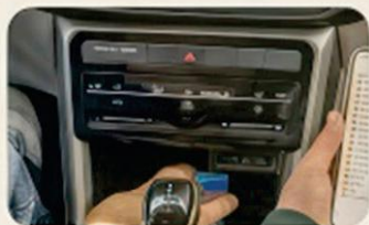
Aire acondicionado Climatronic touch de una zona
