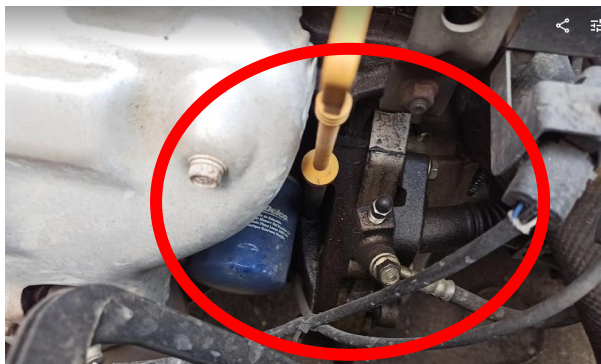
Presencia de aceite en la unión entre el cabezote y el bloque del motor.
