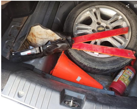
Llanta de emergencia, gata mecánica, llave de ruedas, extinguidor de incendios y triángulo de seguridad.
