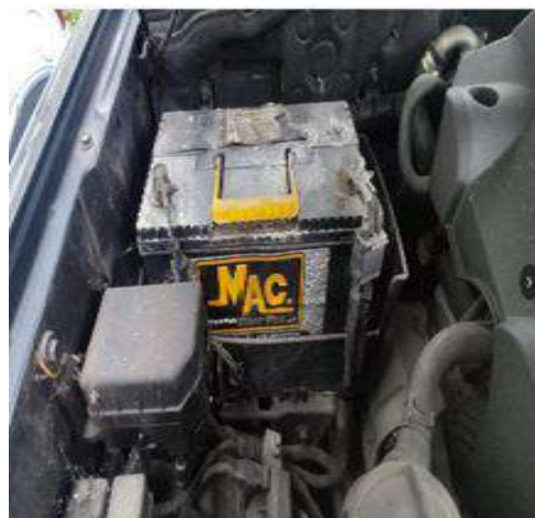
Foto 20.- Bateria en mal estado
