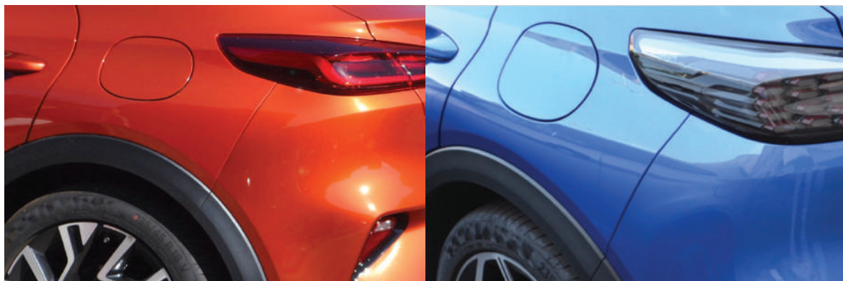
Ilustracja 1. Przykład różnic w odbiorze barwy między elementem metalowym, a nakładką zderzaka wykonaną z tworzywa sztucznego.
