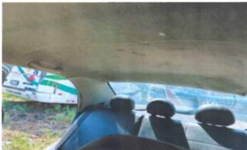
Fotografía 18. Parte del techo, tapizado techo, presenta manchas
