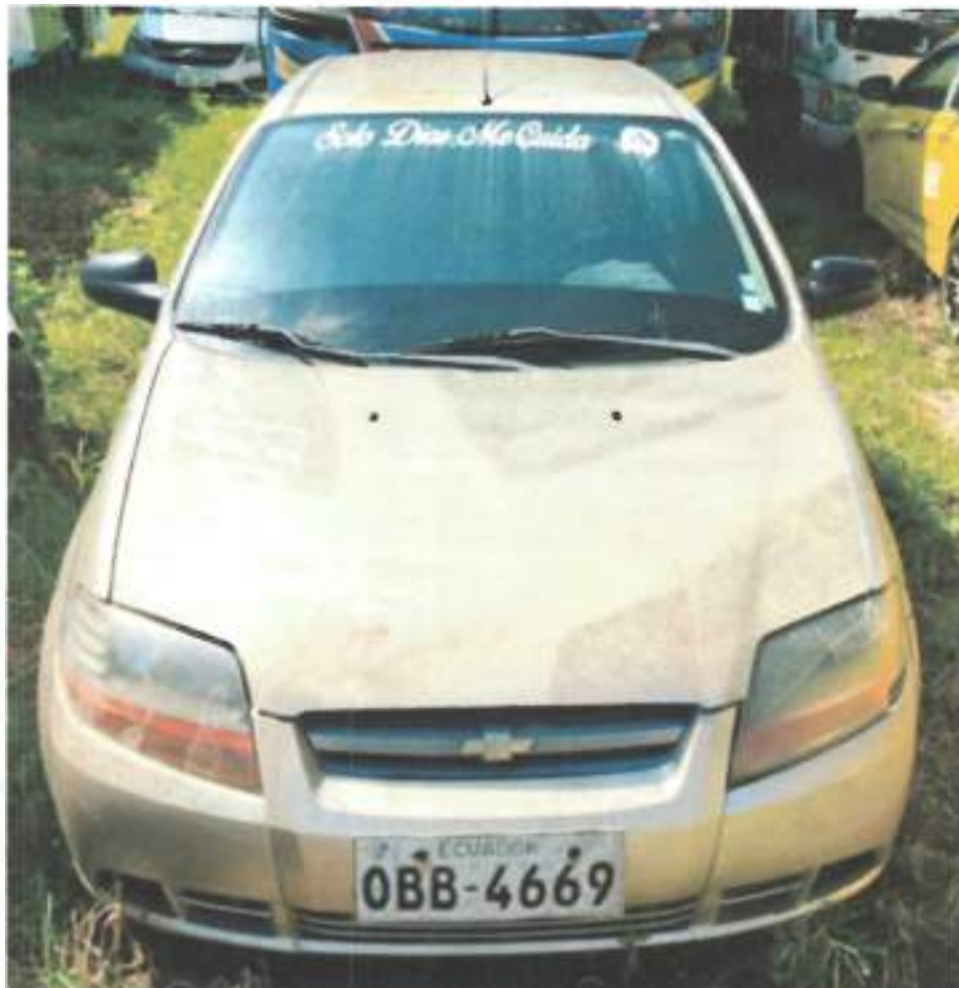
Fotografía 4. Parte Frontal externa, fardo izquierdo se encuentra roto, fardo derecho se encuentra opaco en su mica
