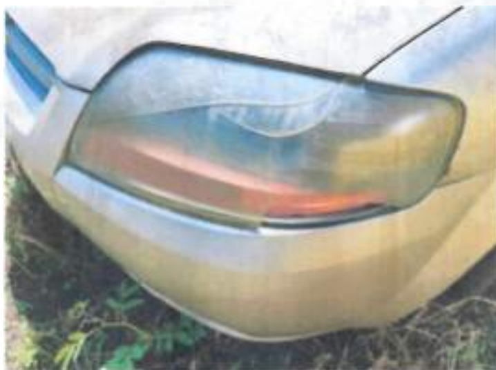
Fotografía 25. Faro delantero izquierdo se encuentra roto y fisurado
