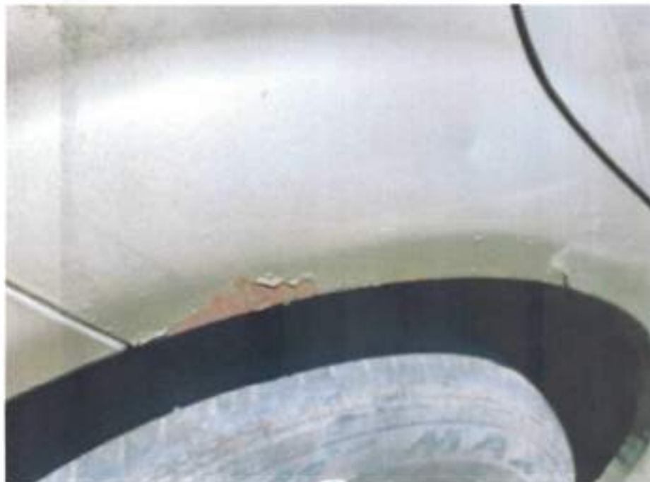
Fotografía 29. Parte posterior a la puerta derecha posterior, presenta corrosión y desprendimiento de pintura.
