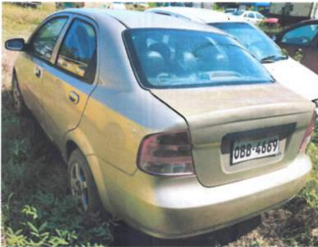
Fotografía 5. Parte posterior externa, pintura de cajuela parte superior se encuentra muy opaca y quemada.
