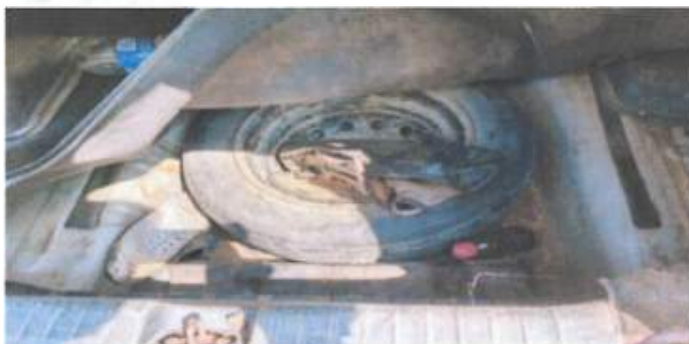
Fotografía 19. contorno de cajuela presenta varios punto con corrosión
