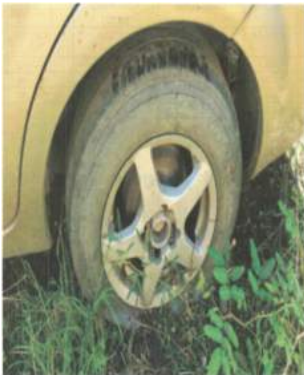
Fotografías 30, 31. Neumáticos posteriores izquierdo y derecho presentan desgaste en su banda de rodamiento
