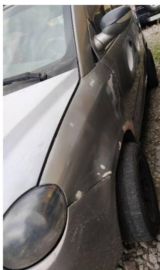
Llantas en mal estado, golpes laterales
