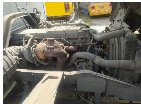
VISTA DE SISTEMA DE INYECCIÓN.DE AIRE (TURBO)
