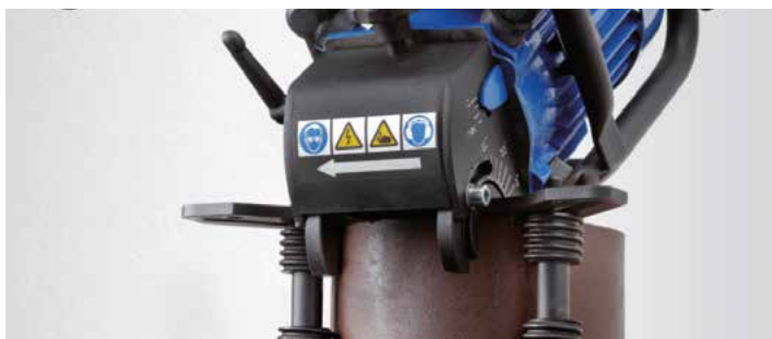
Usinage des chants de tubes en position verticale
