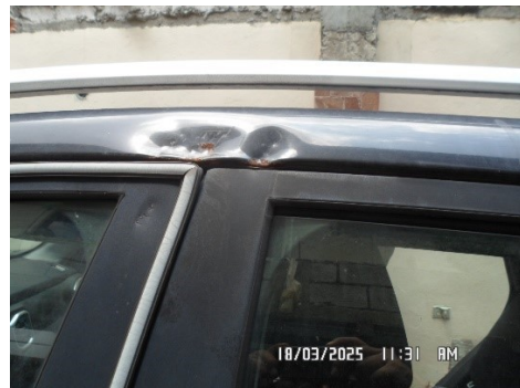
VISTA DE GOLPE EN PARTE SUPERIOR DE MARCO DE PUERTAS.
