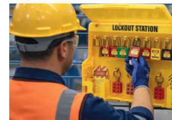
ESTACIÓN DE BLOQUEO
