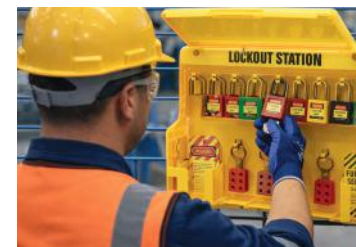
ESTACIÓN DE BLOQUEO
