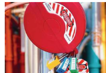
BLOQUEO DE VÁLVULAS
