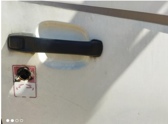
CHAPA DESMONTADA EN PUERTA DERECHA
