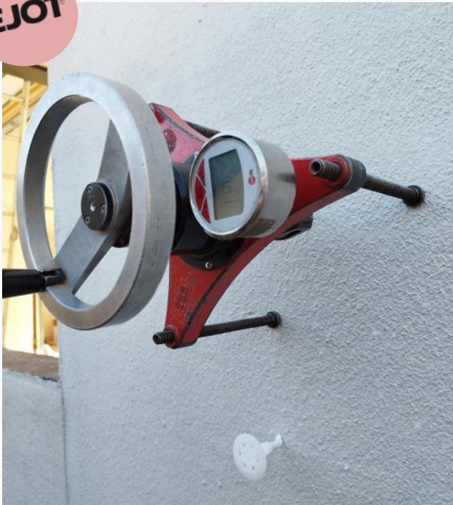
prueba de arrancamiento del anclaje
