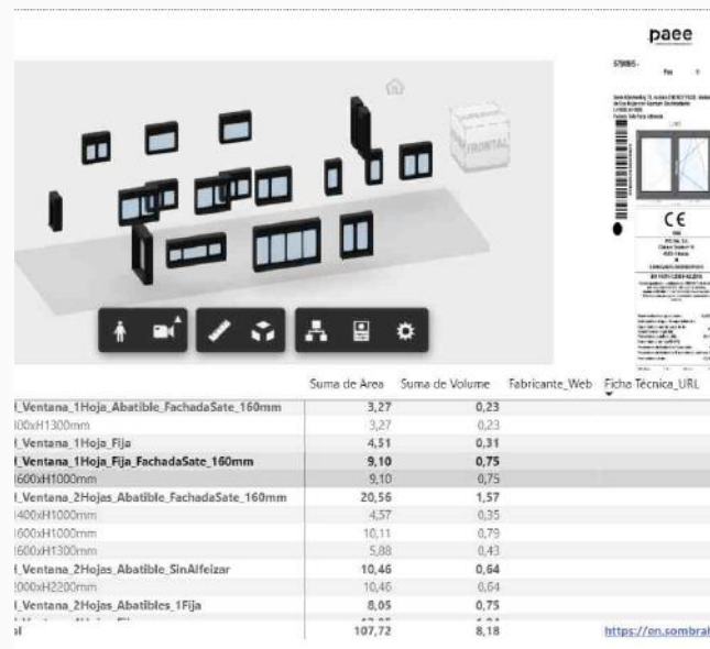
libro del edificio digital, ventanas
