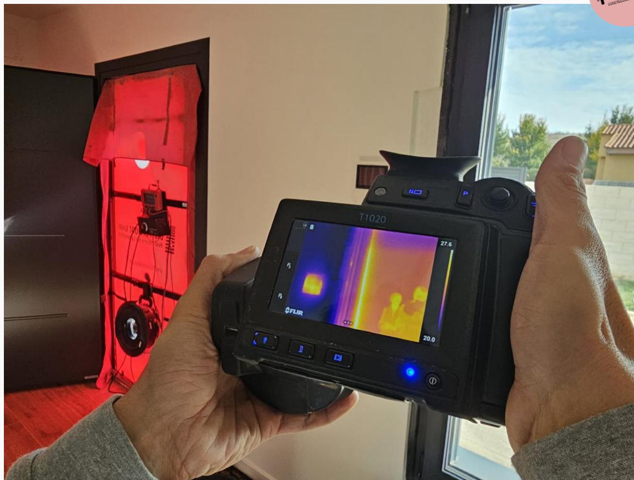
cámara termográfica durante test blower door
