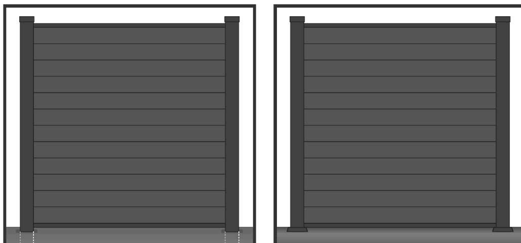
FIG. 1 — OPCIONES DE INSTALACIÓN — CIMENTACIÓN DE HORMIGÓN (IZQUIERDA) Y BASE PREPARADA (DERECHA)
