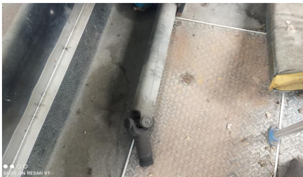
EJE DE TRANSMISION DESMONTADO Y COLOCADO DENTRO DE CABINA
