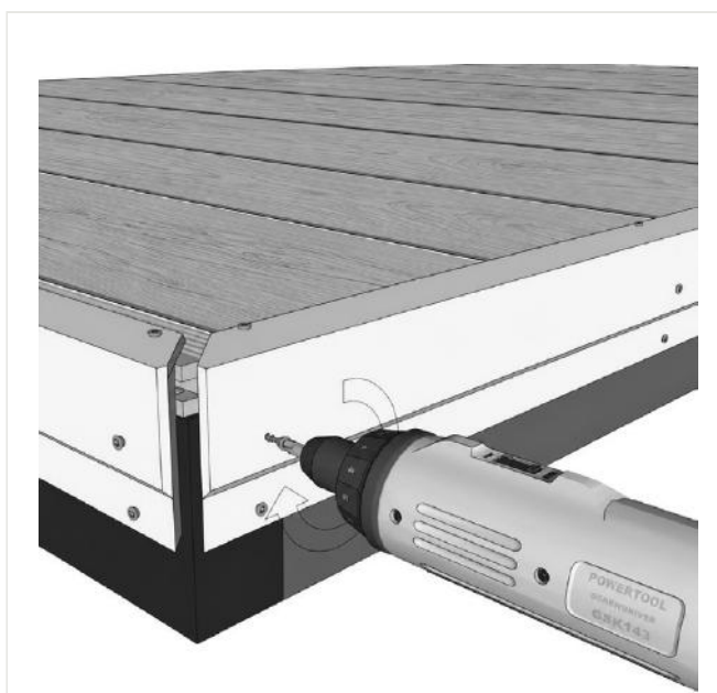
FIG. 26 – PROFILÉ D'ANGLE FIXÉ AVEC DES VIS FRAISÉES
